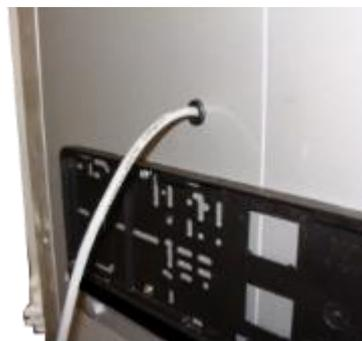
Kabel für die Kennzeichenbeleuchtung
