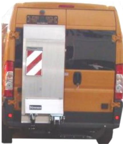
Standardmäßig ist die Kennzeichenbeleuchtung und das Kennzeichen am Fahrzeug über der Ladebordwand angebracht.
