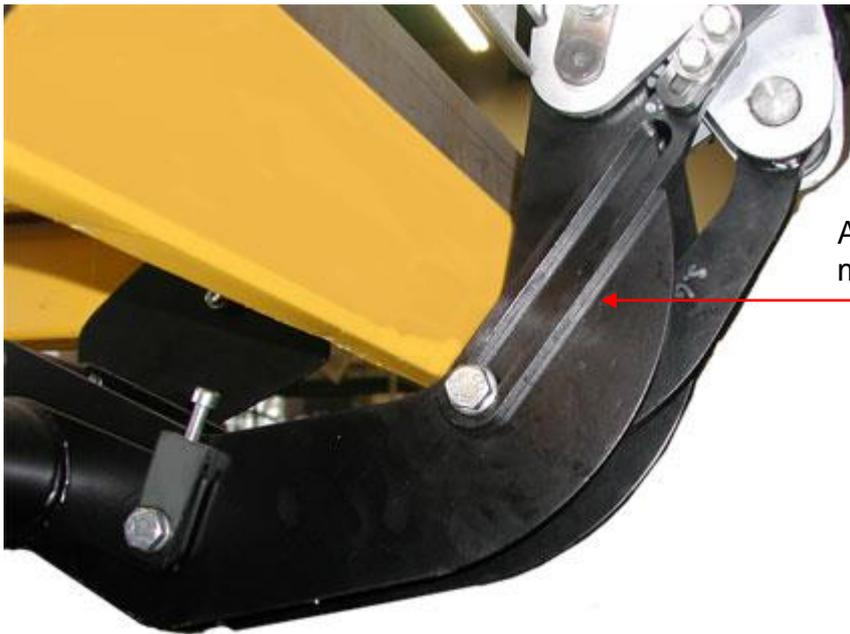
Anschlag der Plattform montiert am Schließarm.
