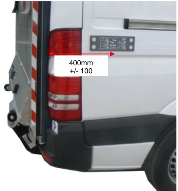
Das Steuerpanel wird mit vier M5 Schrauben im vorgeschriebenen Abstand (siehe Zeichnung) befestigt.
