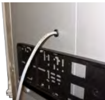
Kabel für die Kennzeichenbeleuchtung
