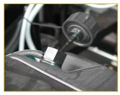
Den Ölstand messen wenn die Ladebordwand bis zum Boden abgesenkt und abgeneigt ist. Ölsorte: HLPD 22 2
