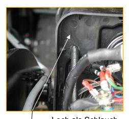
Loch als Schlauchdurchführung bohren 45 mm
