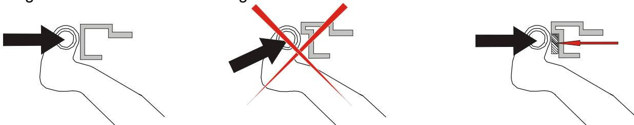
Mit dem Hubarmkopf immer gegen eine Fläche des Heckrahmens fahren. Eine Kante im Bereich Heckrahmen/Hubarmanschlag so auffüllen, dass in jedem Fall ein flächiger Anschlag vorhanden ist. Der Aufbau könnte unter Umständen angehoben werden und das Federteil im rechten Hubarm der Ladebordwand kann nicht funktionsgerecht arbeiten
