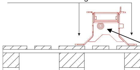
Die Hubwerkseiten links und rechts in den Montagebock stellen und mit den Bolzen vom Montagebock verriegeln.
