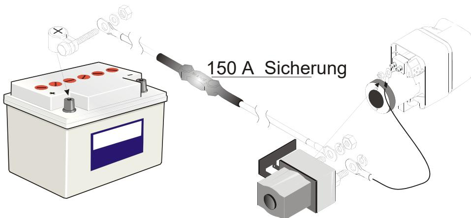
Die Plus- und Masseleitung sind Werkseitig am Aggregat der Ladebordwand montiert. Beide Leitungen zu den vorgesehenen Anschlüssen im Fahrzeug verlegen. Das Massekabel ist blau und das Pluskabel rot. Es ist darauf zu achten, dass keine Scheuerstellen entstehen und die Kabel nicht in der Nähe von wärmeführenden Teilen verlegt werden.
