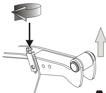
Bei Linksdrehung senkt sich der Hubarm weiter vom Heckrahmen ab
