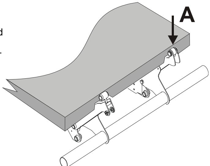
Bei Rechtsdrehung der Schraube in der Einstellgabel fährt der Hubarm höher an den Heckrahmen heran.
