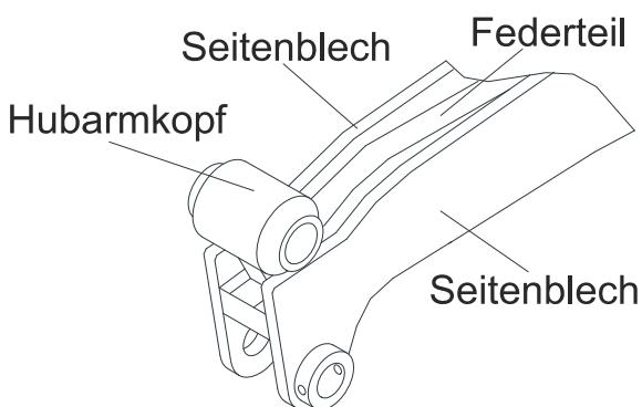
Wenn Sie, wie vorgegeben, montiert haben, schlagen beide Hubarmköpfe gleichzeitig am Heckrahmen des Fahrzeugs an.
